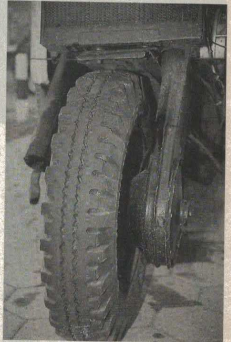
Begegnung mit dem dritten Rad: Auhängung und Antriebseinheit werden mitgelenkt!
